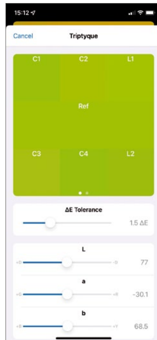
Der Triptique-Simulator ermöglicht eine Visualisierung des gewählten Delta E-Abstandes
